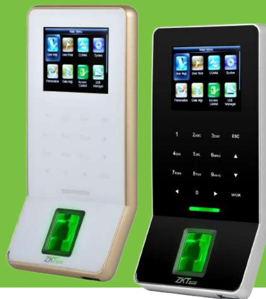
F22 es una terminal biométrica ultradelgada para control de acceso y gestión de asistencia de empleados, integrado con sensor BioID y comunicación Wi-Fi, lo que en conjunto con su avanzado y veloz algoritmo, ofrece un gran, confiable y preciso rendimiento.
